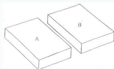
침투제 비교시험편은 두께가 3/8 in.(9.5mm)이고 시험치수가 2 in. x 3 in. (50mm x 75mm)인 알루미늄을 가열 후 급랭하여 미세균열을 만든 후 1/2로 절단한다.
