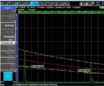
Veo는 단일 트랜스듀서를 사용한 전통적인 초음파 시험을 지원한다. 높은 선명도의 LCD 및 신속한 그래픽 렌더링은 높은 수준의 정확도와 신속한 쌍방향 파장 디스플레이를 가능하게 한다. 높은 해상도의 LCD 디스플레이를 활용해서 측정값은 선명하고 용이하게 읽을 수 있으며, 넓은 화면 포맷을 방대한 스캔 뷰잉 면적을 제공한다. A-스캔 디스플레이를 활용해서 피크 신호를 반드시 표시할 수 있으며, 이를 통해서 결함을 놓치는 일이 없게 된다.
